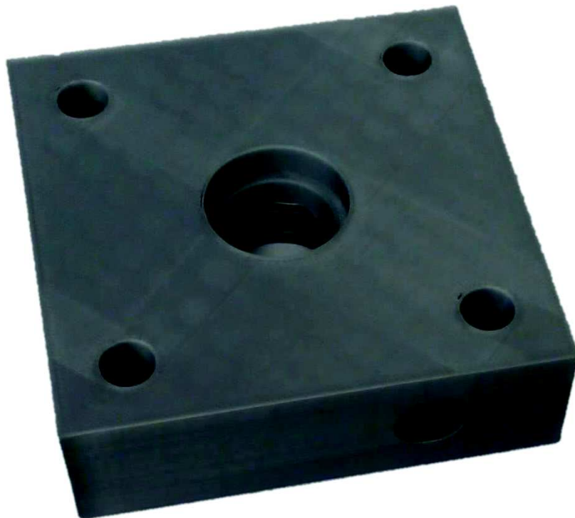
Obrázek 31: Vstupní těleso vyrobené aditivní technologií
