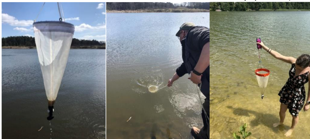
Obr. 21,22,23 – Síť na fytoplankton a jeho odběr
