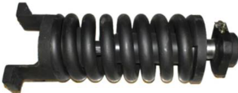
Obr. 11 Hydraulický napínací mechanismus s pružinou [14]
