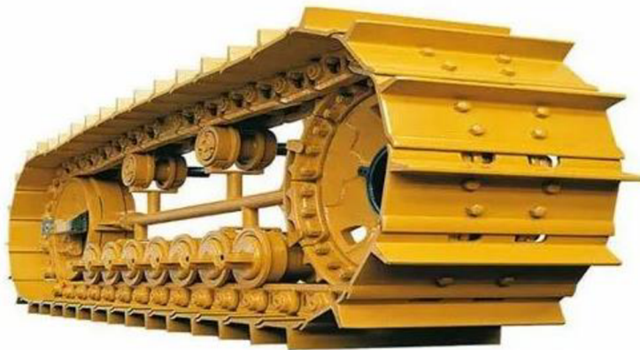
Obr. 20 Ocelový pás pro buldozer [21]
