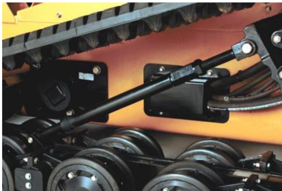
Obr. 12 Napínací mechanismus pásového nakladače CAT D Series [15]
