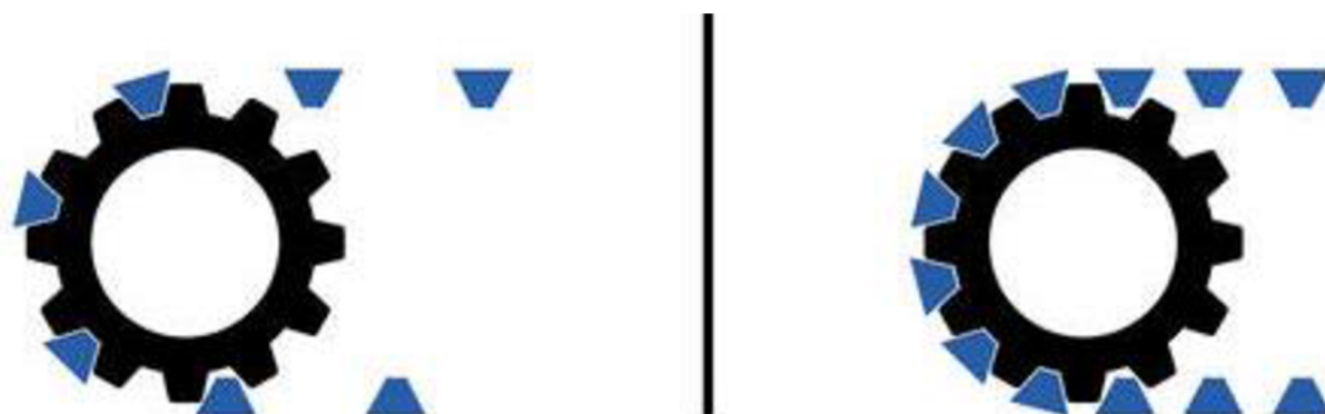
Obr. 15 Pás s dlouhou (vlevo) a krátkou roztečí (vpravo) [17]
