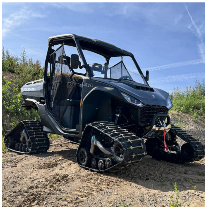
Obr. 23 Camso UTV 4S1 na UTV vozidle [23]
