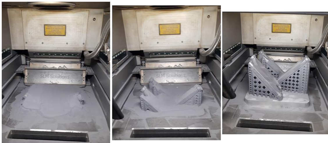
Obr. 13-2: Funkční vzorky uvnitř stavební komory SLM 280 HL (postupné zbavování nespečeného prášku)
