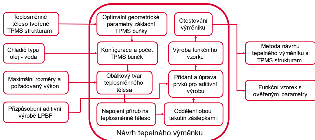
Obr. 4-2: Glass box – detailní schéma procesu diplomové práce
