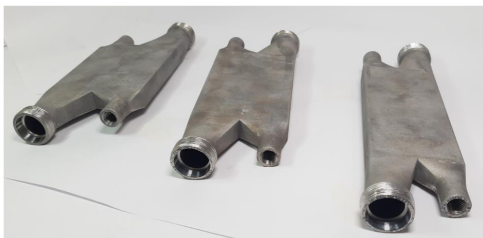
Obr. 6-7: Finální podoba funkčních vzorků (s vyřezanými závity)
