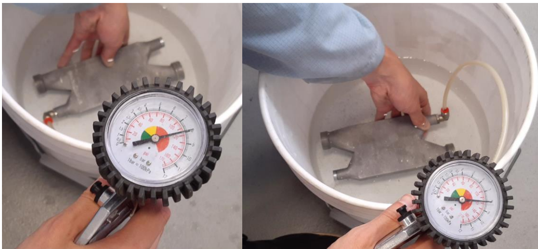
Obr. 13-4: Testování těsnosti funkčních vzorků
