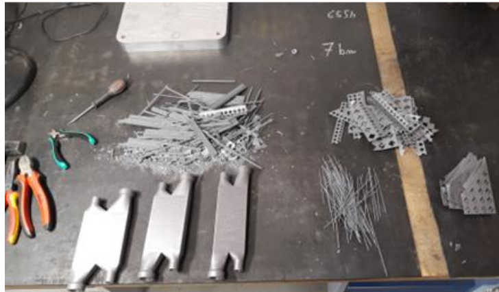
Obr. 13-3: Postprocessing funkčních vzorků: vysypávání prášku (nahore) a odstraňování podpor (dole)
