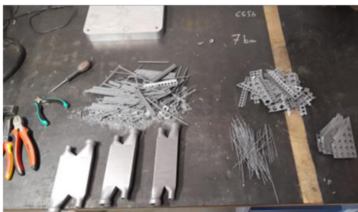
Obr. 13-3: Postprocessing funkčních vzorků: vysypávání prášku (nahore) a odstraňování podpor (dole)
