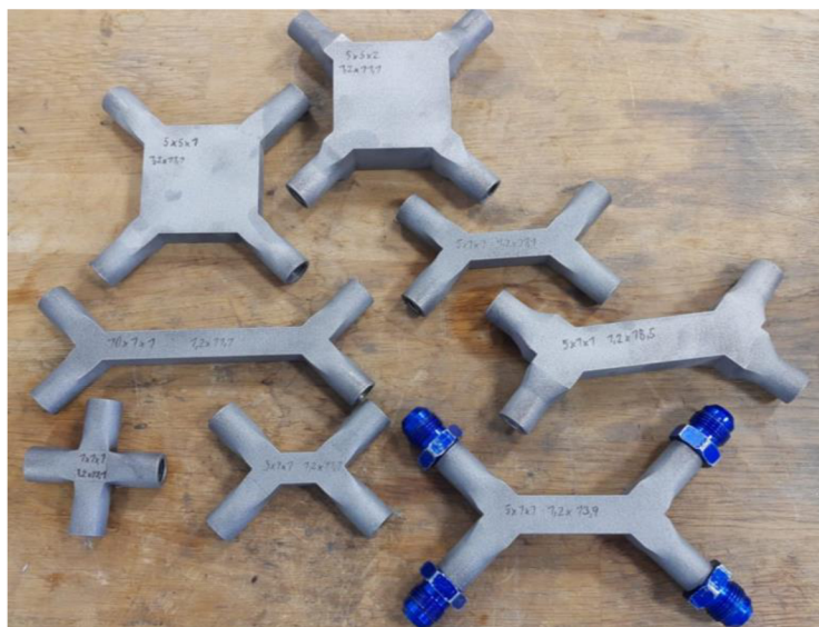
Obr. 4-10: Testovací vzorky pro určení tepelných vlastností konfigurací TPMS struktur
