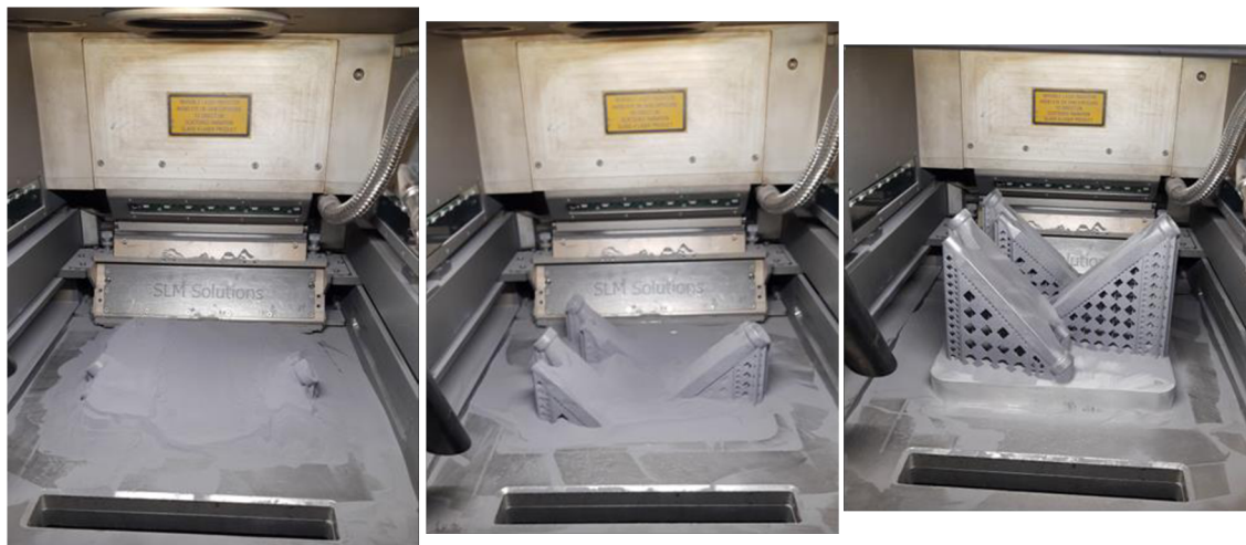
Obr. 13-2: Funkční vzorky uvnitř stavební komory SLM 280 HL (postupné zbavování nespеченého prášku)
