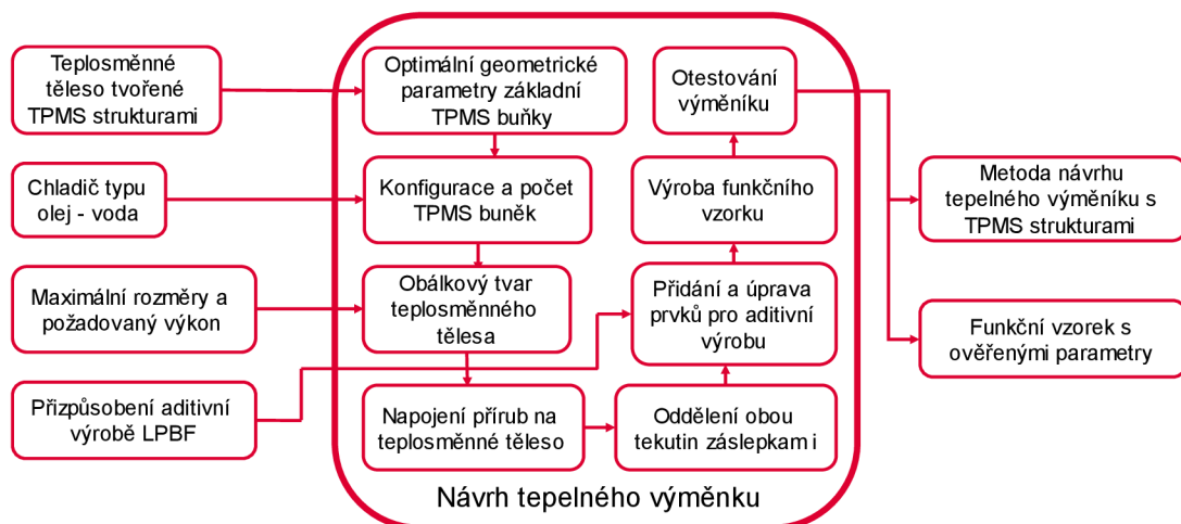
Obr. 4-2: Glass box – detailní schéma procesu diplomové práce
