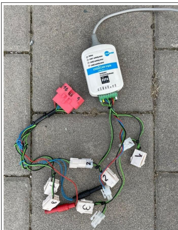
Obr. č. 23 – USB2CAN triple merací prístroj do zásuvky OBD [vlastný]
