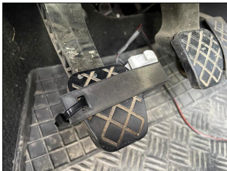
Obr. č. 11 – Upevnenie nosiča pedálového spínača na pedáli [vlastný]
