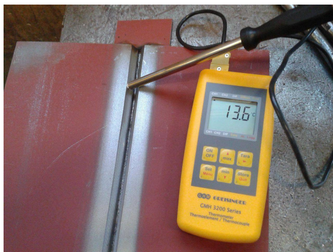
Obr. 31: Ukázka měření teploty materiálu před svařením
