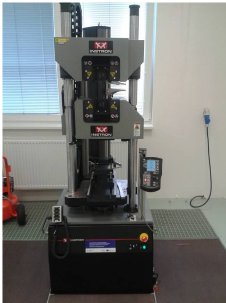
Obr. 29: Univerzální zkušební stroj Instron DX300 / Schéma univerzálního zkušebního stroje (1-dynamometr, 2-průtahoměr, A-vzorek, B-pohyblivý příčník, M-motor, V-vřeteno, P-převodová skříň) /13/
