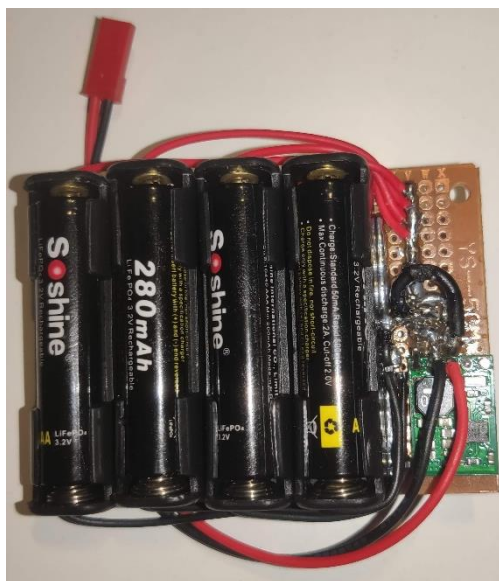
Obrázek 21: Bateriová jednotka s napájecím obvodem – horní pohled
