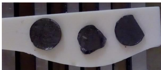
Obr.19 Vzorky složení 0,9 slinované v SPS před vyžiháním
