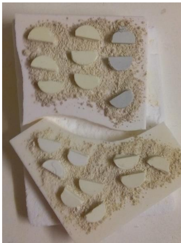
Obr.18 Snímek konvenčně slinovaných vzorků keramiky BaTiO 3 -ZrO 2
