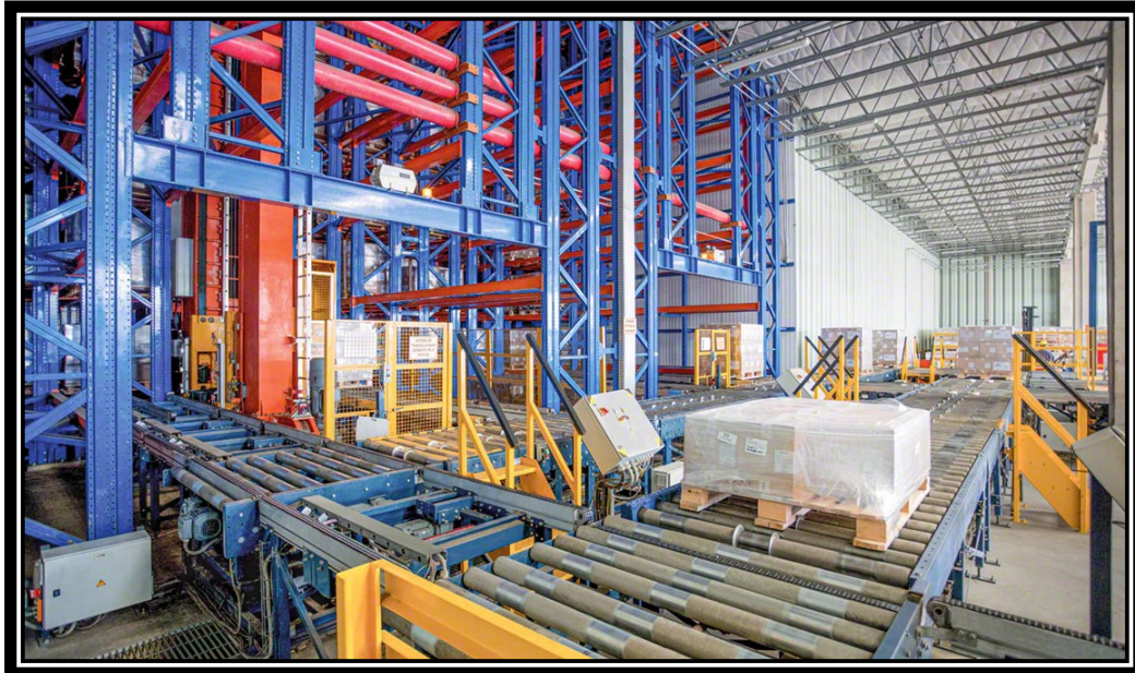
Obr. 3.2 Automatizácia vnútornej dopravy Zdroj: [20]
