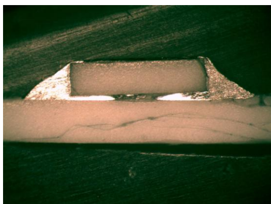
Obr. 26: Výbrus pájeného spoje: pájka NXG1-HF , vzduch.
