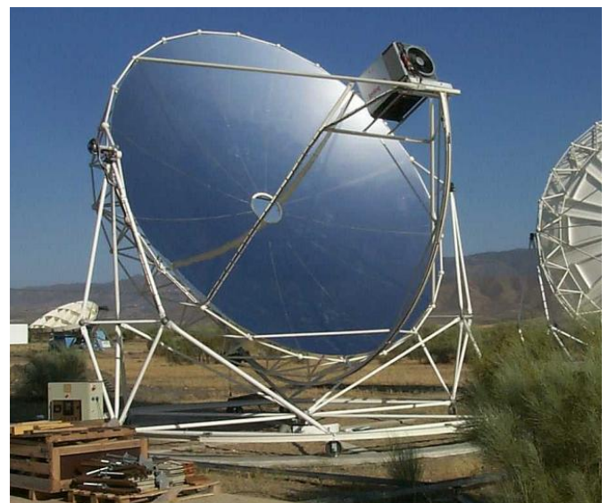
Obrázok 27. Prevedenie výškovno-azimutového sledovacieho systému v praxi [4]
