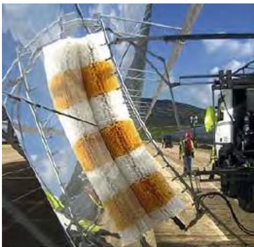
Obrázok 41. Čistenie kefovým systémom [18]
