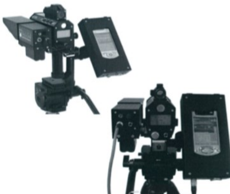
Obr. 1 Kamera, laserový rychloměr, ovládací, zobrazovací a paměťová jednotka (z levé strany do pravé)
