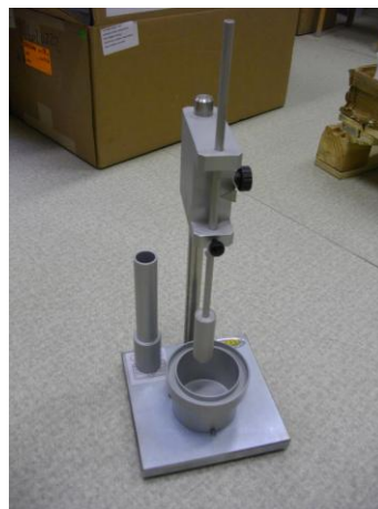
Obr. 15: Příklad pro stanovení hodnoty penetrace
