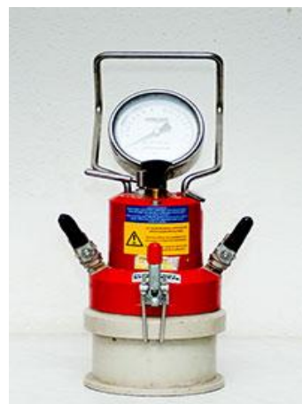
Obr. 19: Příklad pro stanovení obsahu vzduchu
