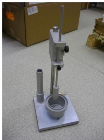
Obr. 15: Příklad pro stanovení hodnoty penetrace
