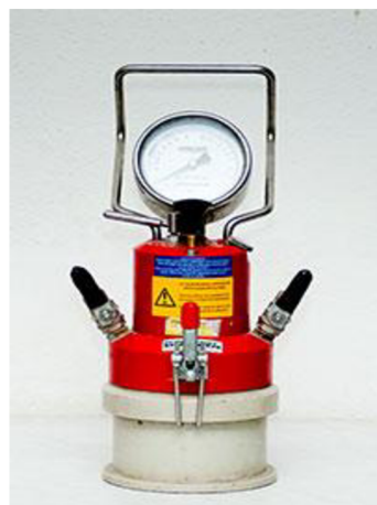
Obr. 19: Příklad pro stanovení obsahu vzduchu
