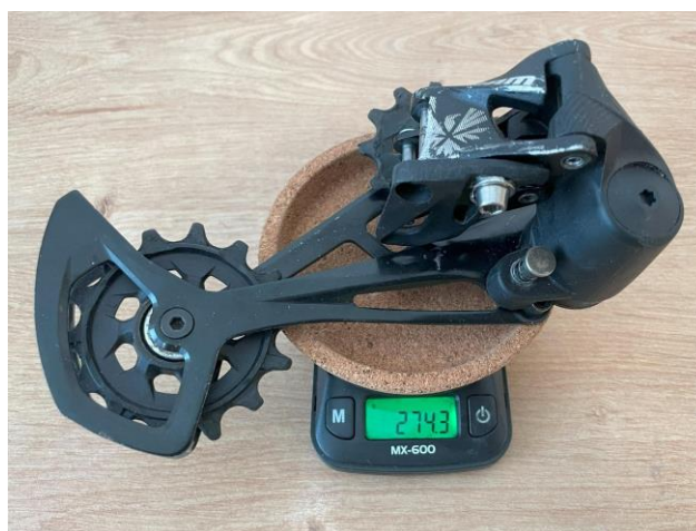
Obr. 5-6 Hmotnost přehazovačky Sram NX Eagle (bez nahrazovaného dílu B-knuckle)
