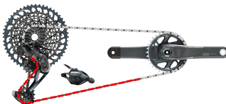
Obr. 5-7 Část řetězu nesena přehazovačkou upraveno dle [3]
