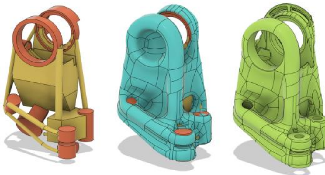
Obr. 5-23 Proces návrhu výchozího tvaru generativního designu
