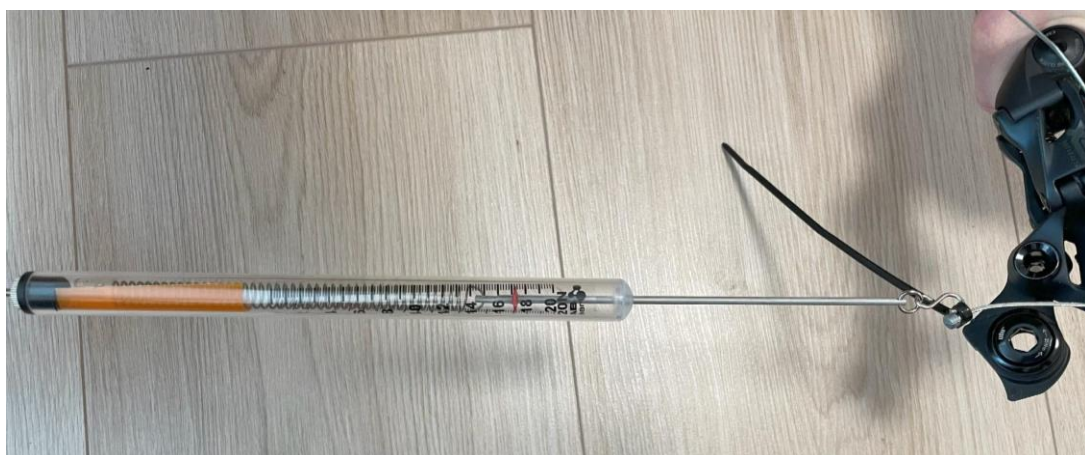
Obr. 5-3 Měření předepnutí ocelového lanka
