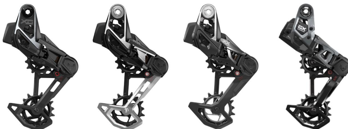
Obr. 2-10 Přehazovačky Sram Eagle Transmission zleva X0, XX, XX SL, GX upraveno z [3]
