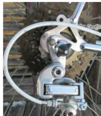
Obr. 2-12 Uchycení přehazovačky pomocí hákového držáku [5; 14; 15]
