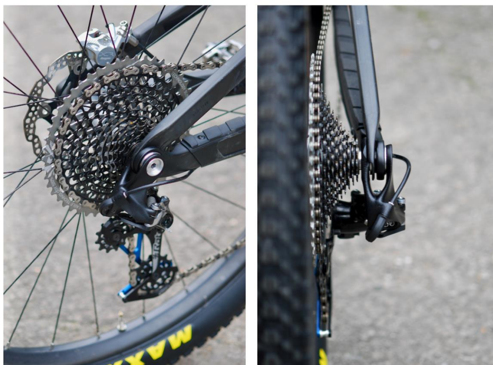
Obr. 2-11 Prototyp adaptéru pro montáž standardní přehazovačky bez použití patky [13]
