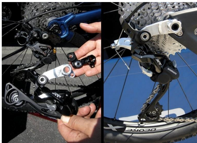
Obr. 2-9 Přehazovačka Shimano Deore XT vybavená systémem Shadow [10]
