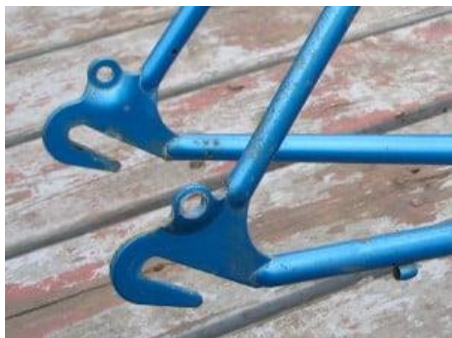
Obr. 2-12 Uchycení přehazovačky pomocí hákového držáku [5; 14; 15]
