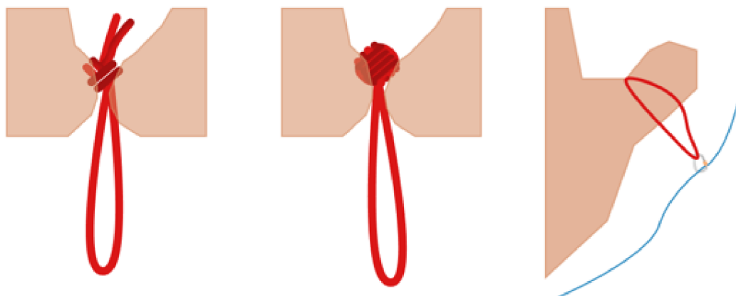
Obrázek 12 Vlevo můžeme vidět ideálně založený uzel, uprostřed opičí pěst a napravo obhoz, vlastní zpracování
