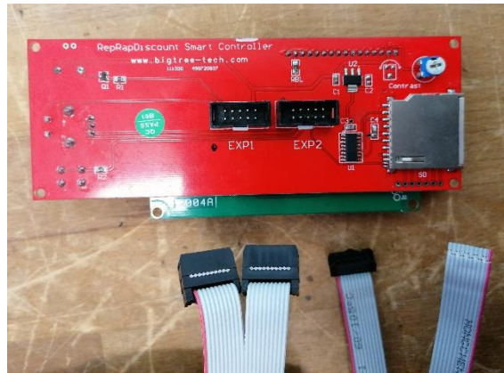
Obr. 66 Kabely na displej
