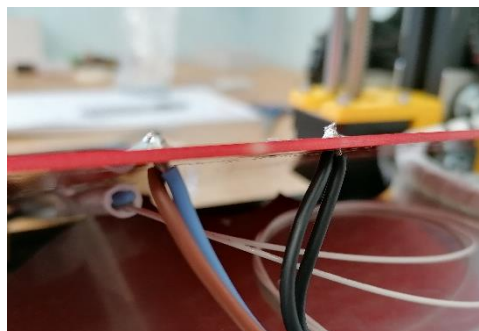
Obr. 71 Připájené napájecí kabely
