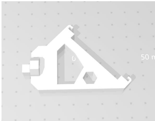
Obr. 61 Uchycení tištěného spoje do rámu – Pravá strana – Autor: Michael McClinton
