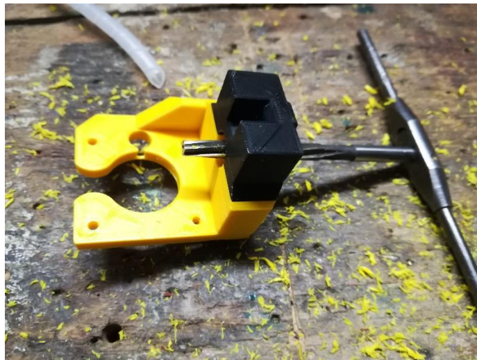
Obr. 20 Úprava otvoru na šroub
