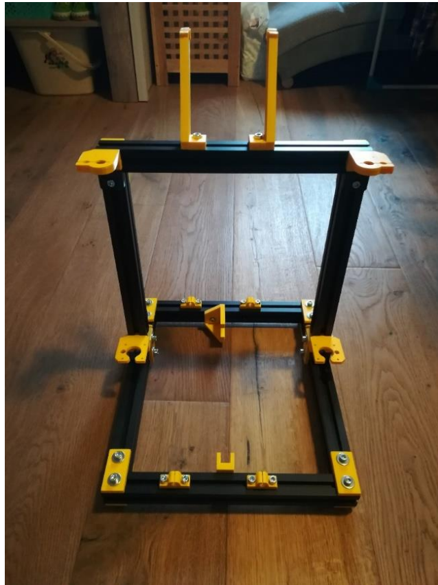
Obr. 36 Spojení základny s rámem
