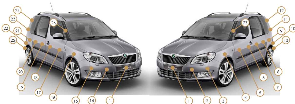
Obr. 24 Schéma umístění odběrných míst tlaku na povrchu vozidla
