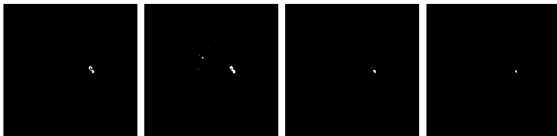
Obr. 2.8: Srovnání výsledků prahování – nalevo skutečná maska, pak predikové masky s prahy 48, 80 a 112
