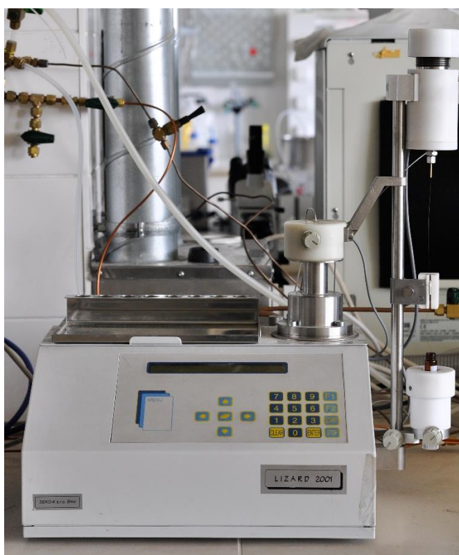
Obr. 10 Přístroj pro superkritickou fluidní extrakci značky Lizard 2001 firmy Seko-K, Brno
