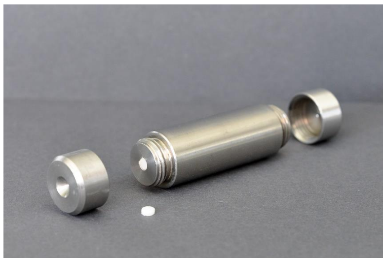
Obr. 30 Patrona pro superkritickou extrakci společně s filtrem v podobě polyethylenové frity
