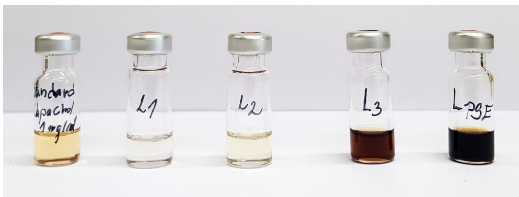
Obr. 35 Srovnání extraktů lapacha získaných superkritickou a vysokotlakou extrakcí společně se standardem lapacholu. L3 - oplach patроны
