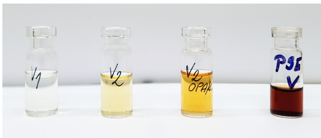
Obr. 33 Srovnání extraktů vilcacory při superkritické a vysokotlaké extrakci
