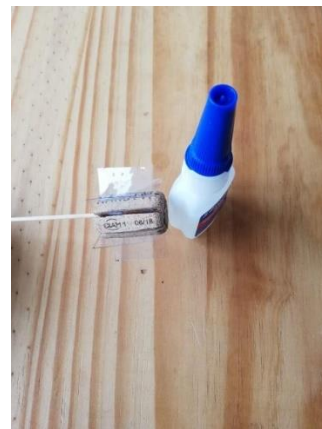
Obr. 72 – 73: Obdélníkové lopatky 3 cm x 2 cm vystříhneme a přilepíme do zářezů v zátce.
