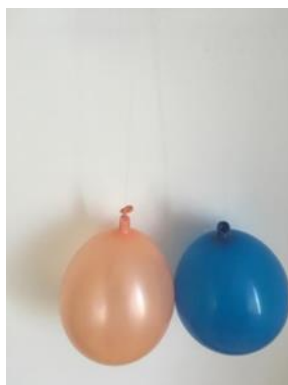
Obr. 28: Dva balonky žáci pověsili na provázek. Třením o sebe se balonky vzájemně nabily a přitahovaly se k sobě.
