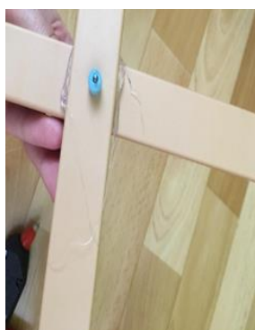
Obr. 105: Přilepíme obě laťky k sobě, aby držely u sebe.
