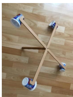
Obr. 106 – 109: Hřebík s nasazeným křížem a upevněnými kelímky zatlučeme do dřevěné tyčky, která slouží jako držák.
