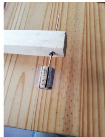
Obr. 74 – 76: Do dřevěné lišty vyvrtáme otvor a do něj zasuneme dutý hliníkový nýt jako ložisko osy vodního kola. Na osu nasuneme zářezku z gumového vodovodního těsnění, zasuneme ji s vodním kolem do otvoru nýtu a z druhé strany zajistíme další zářezkou.
