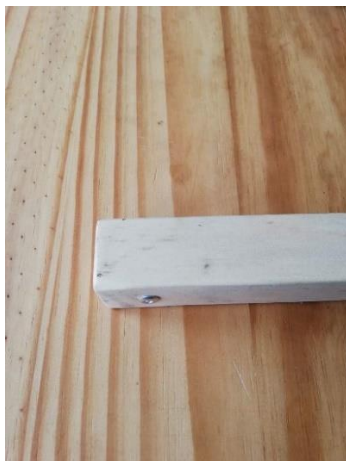
Obr. 74 – 76: Do dřevěné lišty vyvrtáme otvor a do něj zasuneme dutý hliníkový nýt jako ložisko osy vodního kola. Na osu nasuneme zářezku z gumového vodovodního těsnění, zasuneme ji s vodním kolem do otvoru nýtu a z druhé strany zajistíme další zářezkou.
