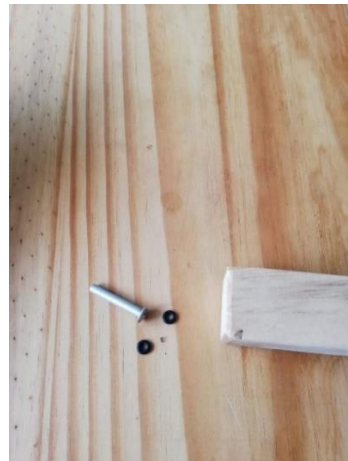
Obr. 74 – 76: Do dřevěné lišty vyvrtáme otvor a do něj zasuneme dutý hliníkový nýt jako ložisko osy vodního kola. Na osu nasuneme zářezku z gumového vodovodního těsnění, zasuneme ji s vodním kolem do otvoru nýtu a z druhé strany zajistíme další zářezkou.
