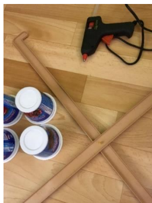
Obr. 103 – 104: Tavicí pistolí přilepíme kelímky od jogurtu na konec každého ramene.
