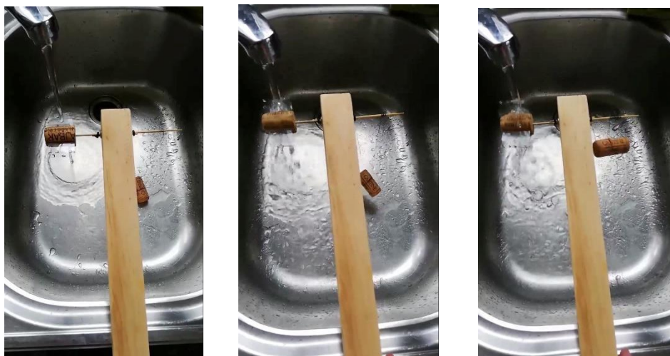
Obr. 77 – 79: Nakonec na niť navážeme korek. Při točení v proudu vody se korek zvedá nahoru.
