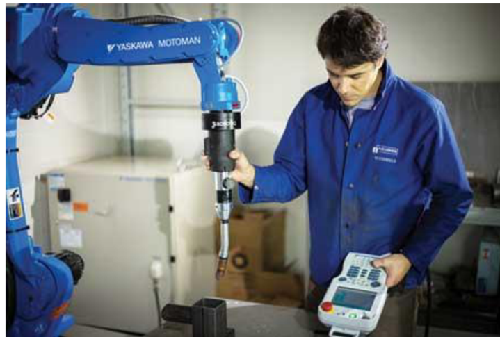
Obr. 3) Princip ručního navádění [11]
