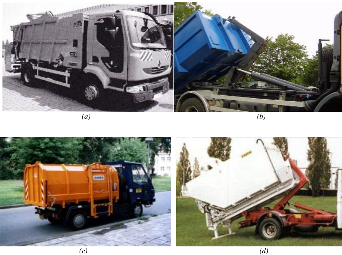
Obrázek 8.3.2 a,b,c,d,e,f,g,h: Vozidla pro dopravu KO USA (a) stand-up right-hand-ride s třemi oddělenými částmi s mechanickým vyprazdňováním (b) stand-up right-hand-ride s třemi nízkými nakládacími částmi (d) stand-up-ride vozidlo s mobilními kontejnery. (f) Vozidla s mechanismem předního nakládání (g) Trash trailer a (h) hoist truck. (Tchobanoglous, Kreith, 2002)
