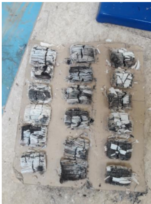
Obrázek 19. Termický rozpad testovaných zkušebních těles. Zdroj: Dědič, 2019
