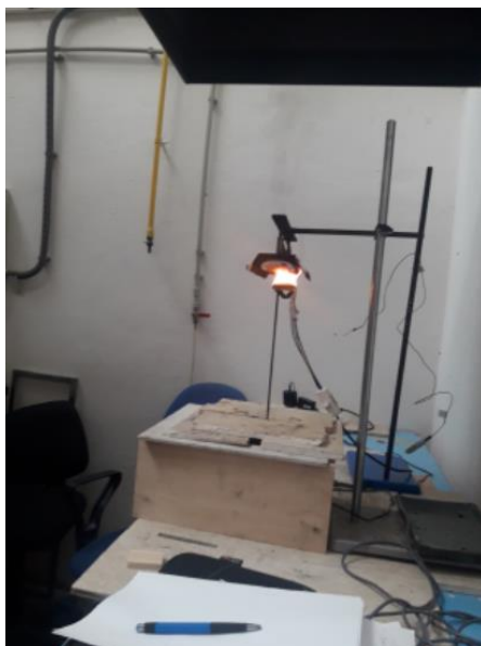
Obrázek 18. Průběh zkoušky hmotnostního úbytku. Zdroj: Dědič, 2019
