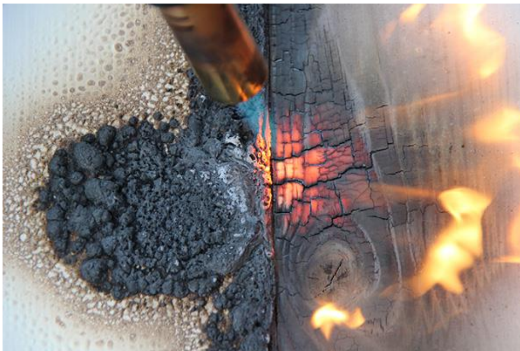
Obrázek 10. Dřevo ošetřené intumescentním nátěrem (vlevo) a neošetřené dřevo (vpravo) při působení tepla. Zdroj: Envirograf, 2016
