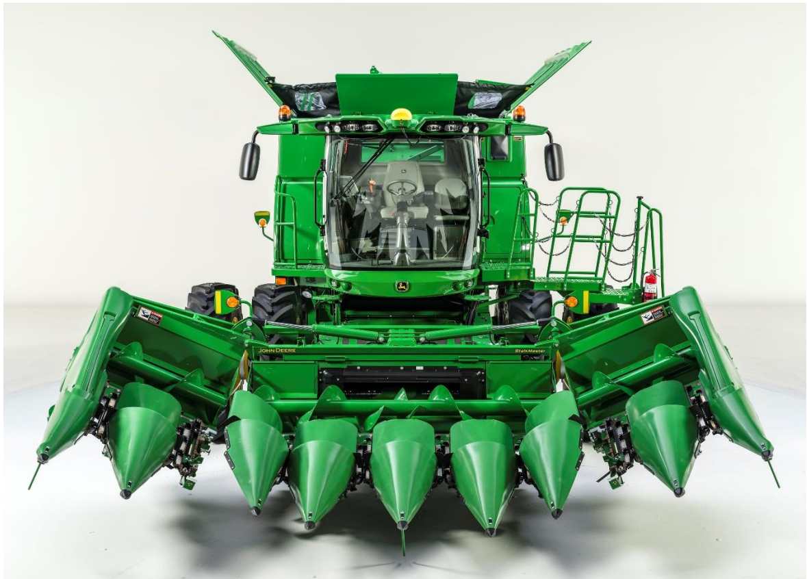
Obrázek č.18: Sklopný osmi řádkový adaptér pro sklizeň kukuřice od firmy John Deere, spolu se sklízecí mlátičkou John Deere [21]
