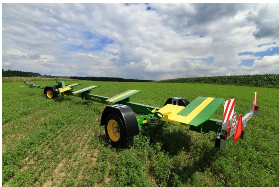
Obrázek č.7: Podvozek sloužící k přepravě adaptérů po pozemních komunikacích [8]
