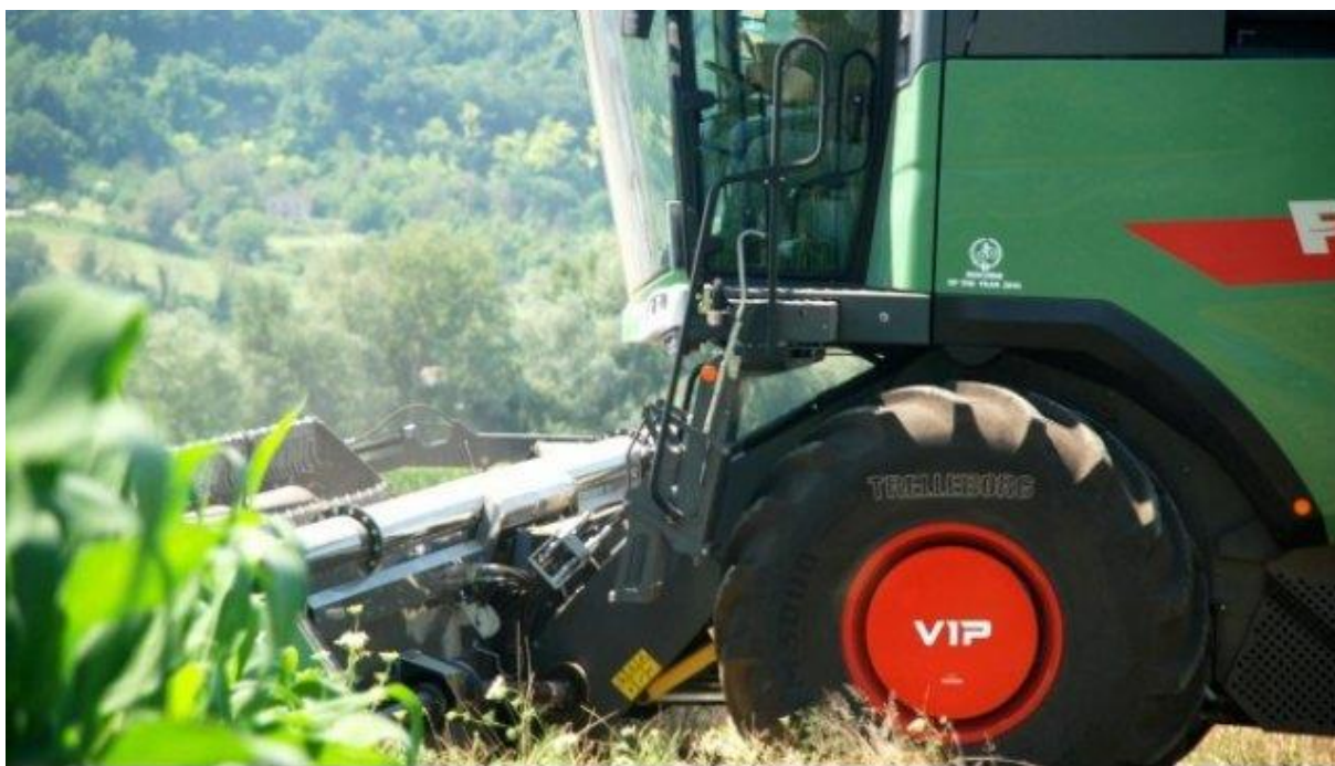
Obrázek č.5: Sklízecí mlátička Fendt vybavená systémem automatické regulace tlaku v pneumatikách [5]
