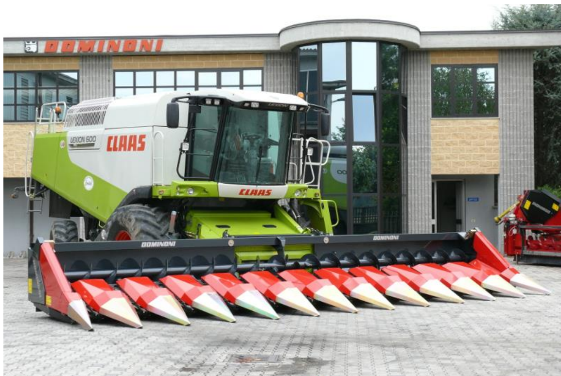
Obrázek č.17: Pevný dvanácti řádkový adaptér pro sklizeň kukuřice od firmy Dominoni, spolu se sklízecí mlátičkou Claas Lexion 600 [20]
