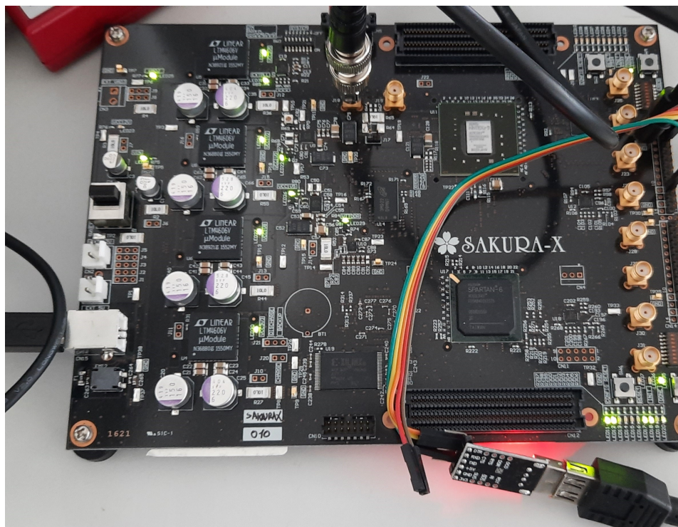
Obr. A.3: Deska SAKURA-X s připojenými sondami pro měření
