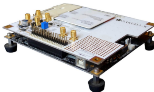
Obr. 3.2: Usazení desky SAKURA–W na desce SAKURA–G. Převzato z manuálu k desce [21].
