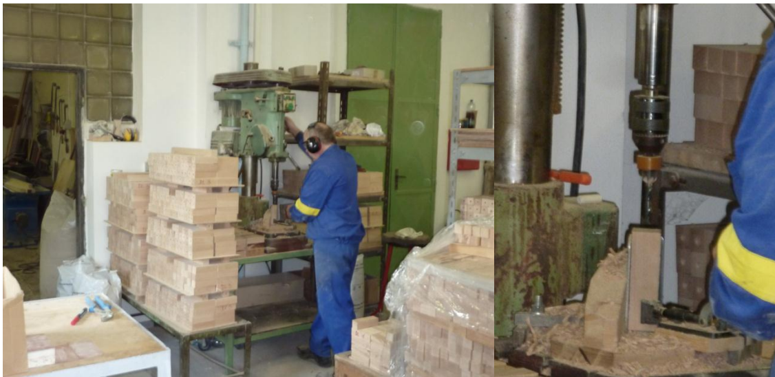
OBRÁZEK 8: VRTÁNÍ HRANOLKŮ NA STOLNÍ VRTAČCE
