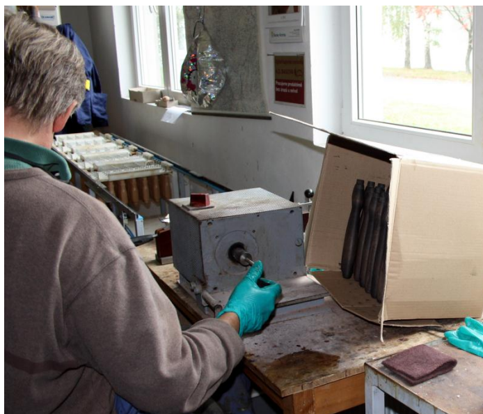
OBRÁZEK 14: MOŘENÍ NA OTOČNÉM TRNU
