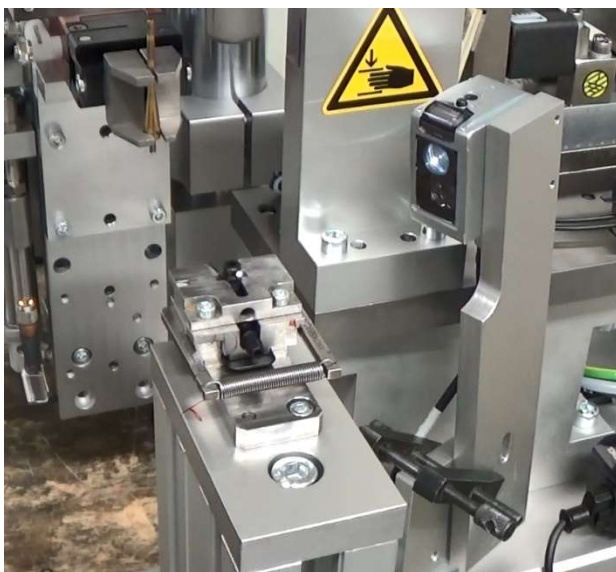
Obr. 31 1. Díl upevněný v poloze pro nasazování
