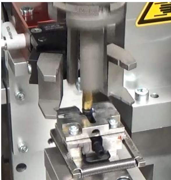
Obr. 35 5. Roztažení a odjezd čelistí
