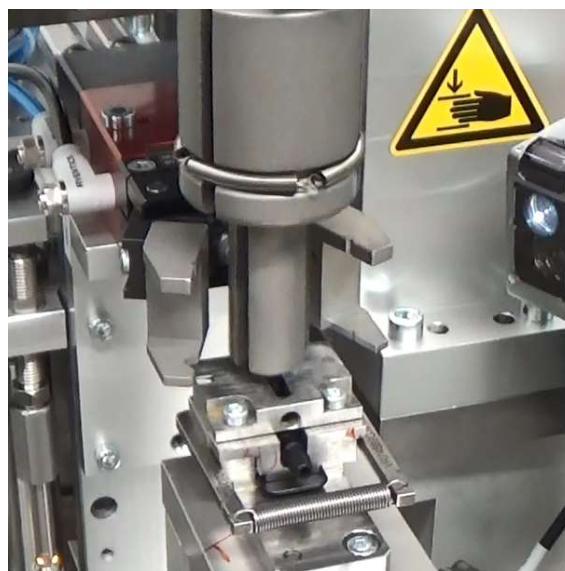
Obr. 34 4. Čelisti pohybem dolů stahují o-kroužek na díl
