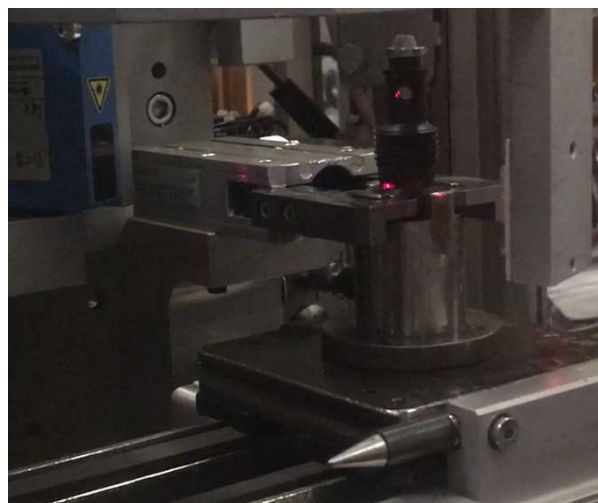
Obr. 42 6. Čelisti přidržující ventil před montáží o-kroužku [13]
