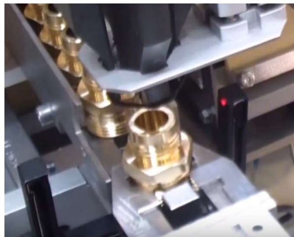
Obr. 46 4. Nájezd roztažených chapadel nad díl [15]
