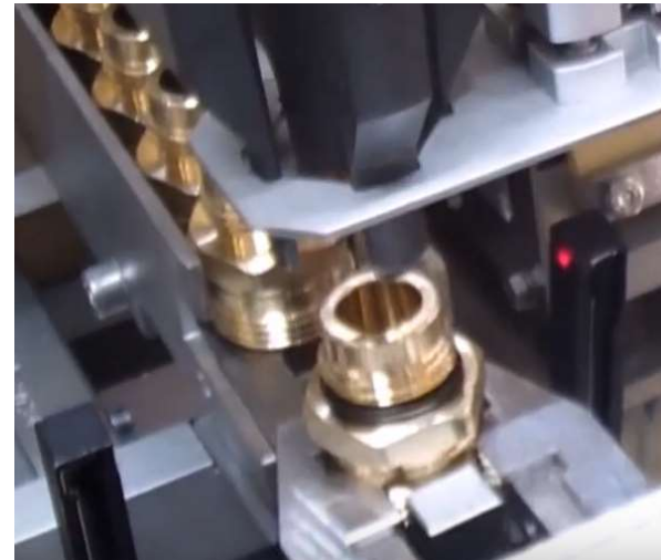
Obr. 48 6. Odjezd hlavy (chapadla roztažena) [15]
