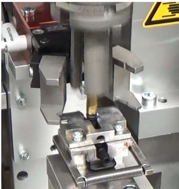
Obr. 35 5. Roztažení a odjezd čelistí
