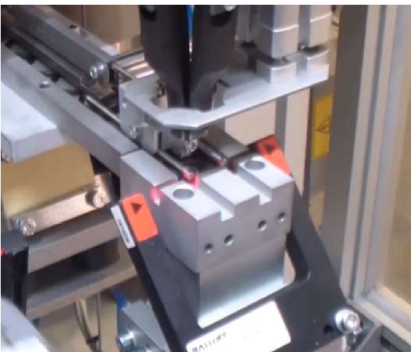
Obr. 43 1. Hlava s chapadly čekající na příjezd výtahu s o-kroužkem [15]
