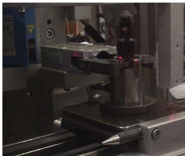
Obr. 42 6. Čelisti přidržující ventil před montáží o-kroužku [13]
