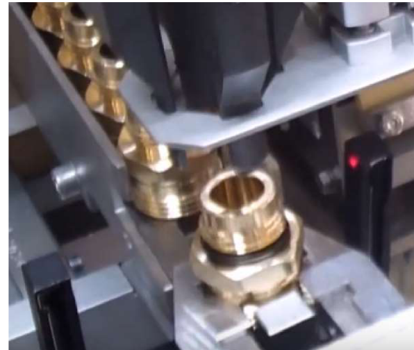
Obr. 48 6. Odjezd hlavy (chapadla roztažena) [15]
