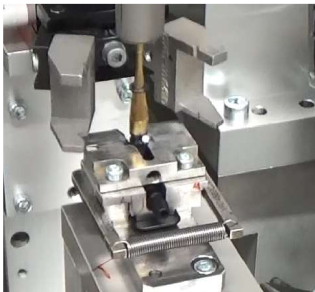
Obr. 33 3. Trn s o-kroužkem umístěn v dílu (čelisti trnu roztaženy)
