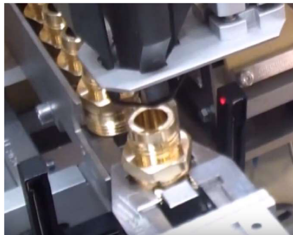
Obr. 46 4. Nájezd roztažených chapadel nad díl [15]
