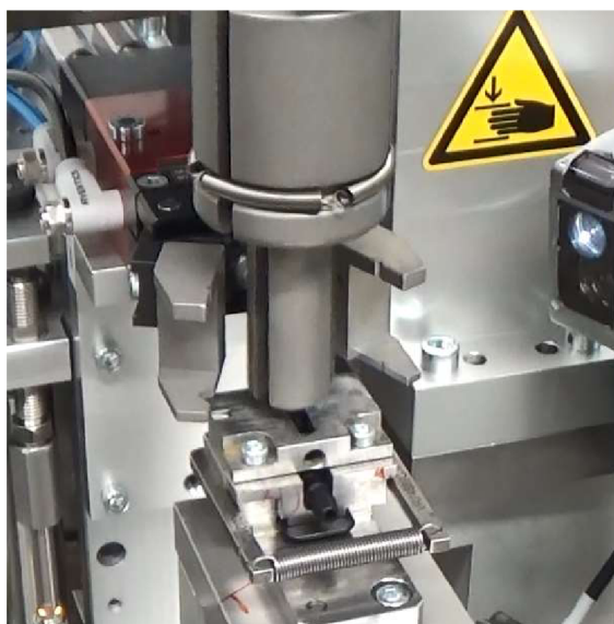
Obr. 34 4. Čelisti pohybem dolů stahují o-kroužek na díl
