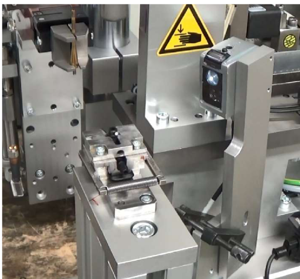
Obr. 31 1. Díl upevněný v poloze pro nasazování
