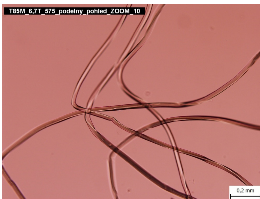
Obrázek 53. Polyesterové bílé vlákno typu solid (plné vlákno bez štěrbin) o jemnosti 6,7 dtex, podélný pohled, 10násobné přiblížení
