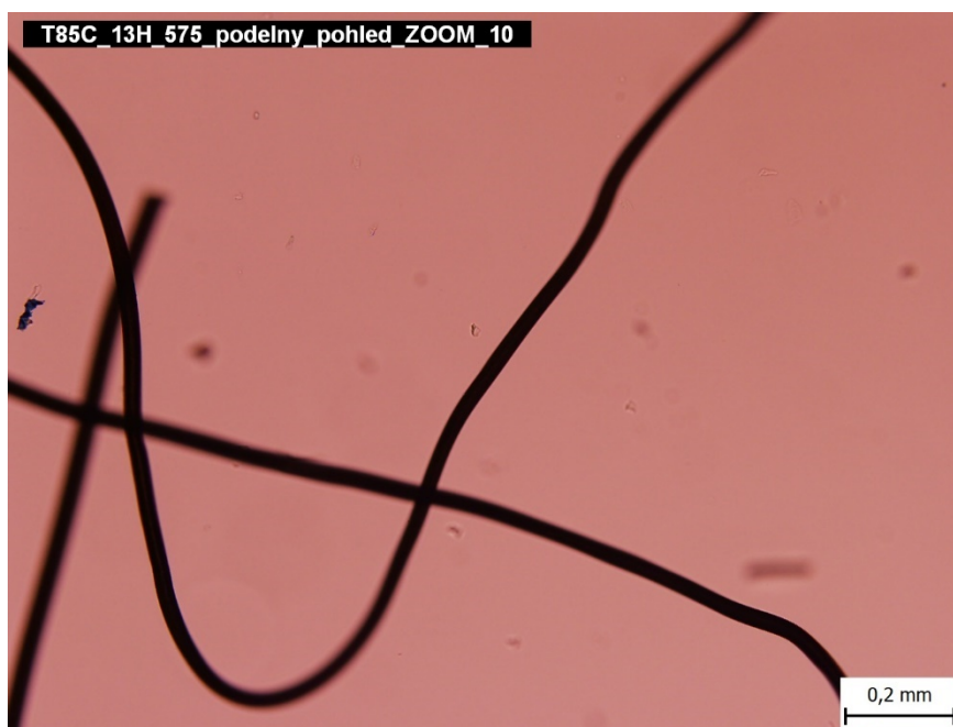
Obrázek 51. Polyesterové tmavé vlákno typu hollow (duté vlákno s jednou štěrbinou) o jemnosti 13 dtex, podélný pohled, 10násobné přiblížení
