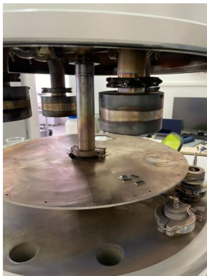
Obrázek 16: Vzorky umístěné v depoziční komoře
