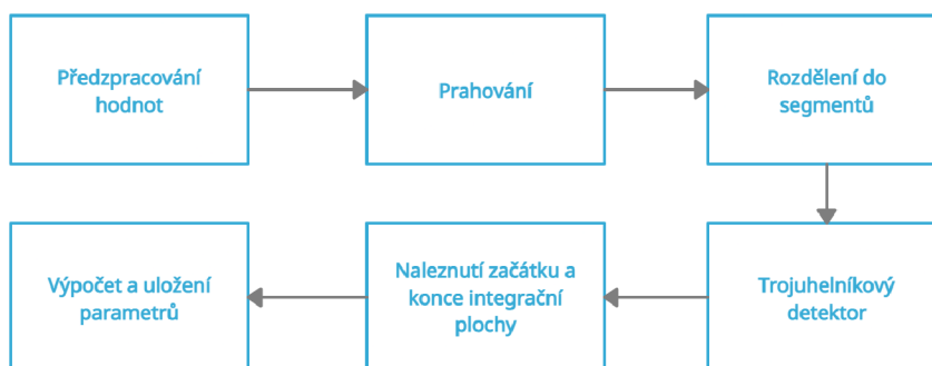
Obr. 3.3: Blokový diagram algoritmu pro nalezení hodnot
