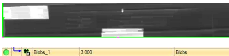
Obr. 33: Výsledný obraz po aplikaci filtrů Optical density, roztažení a uzavření
