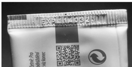
Obr. 25: Směrované horní osvětlení
