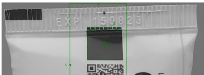
Obr. 28: Hledání referenčního čtverce pomocí hledání blobů.
