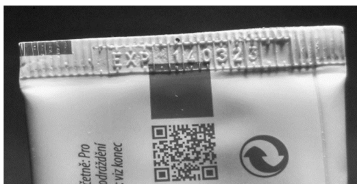
Obr. 25: Směrované horní osvětlení
