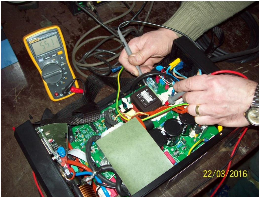
Obrázek 34: Měření nabíjecího obvodu
