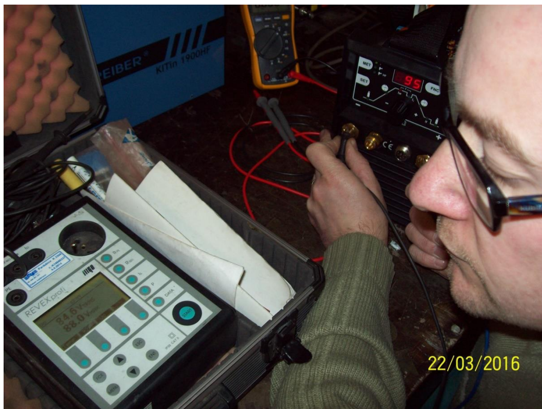
Obrázek 38: Měření napětí naprázdno a při zatížení
