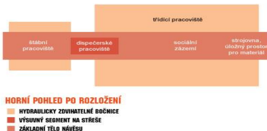
Obrázek 7 - Schéma rozložení modulu Golem
