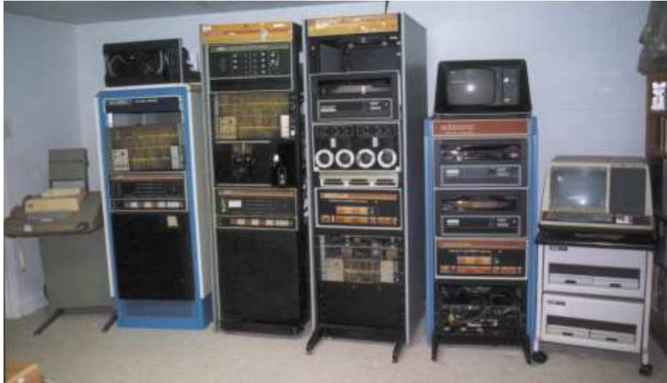
Obrázek 6: PDP-8 (uprostřed s periferiemi po stranách) byl první masově vyráběný „minipočítač“ [3]
