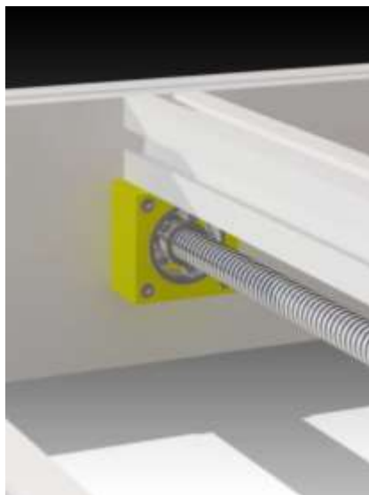
Obrázek 28: Detail uchycení ložisek s kosoúhlým stykem ZKL 7200
