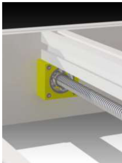
Obrázek 28: Detail uchycení ložisek s kosouhlým stykem ZKL 7200
