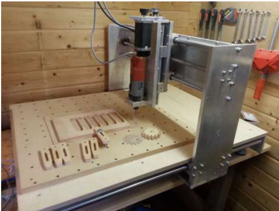
Obrázek 8: Malá 3 osá CNC frézka uživatele Benne [6]
