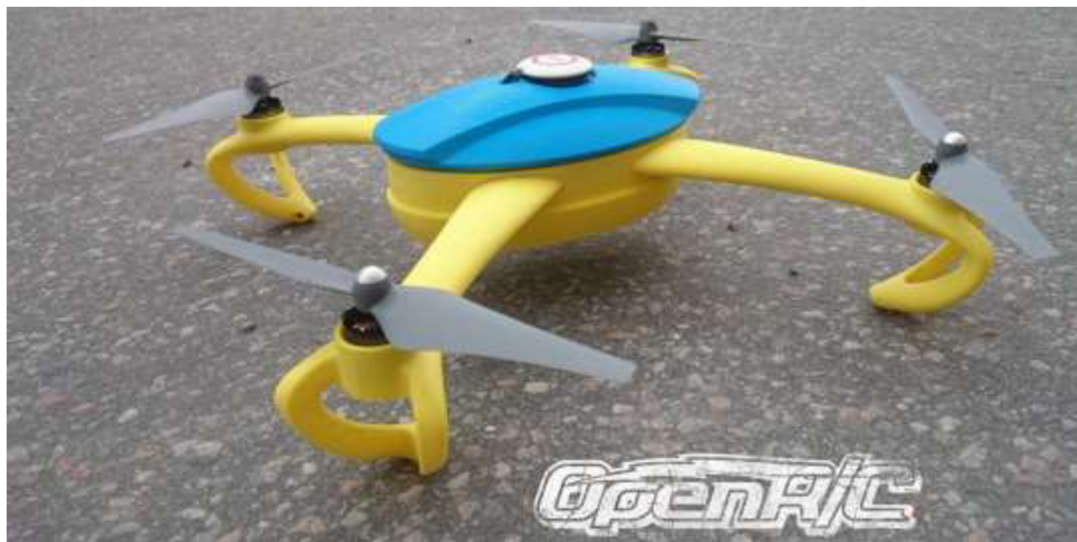
Obrázek 9: Kvadroptéra vytištěná metodou FDM [8]
