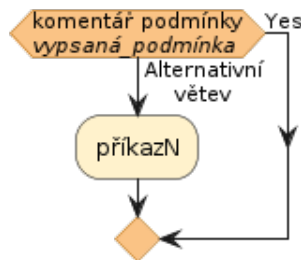
Obr. 5.3: Část diagramu prezentující možnosti dokumentace podmínek vygenerovaný ze zdrojového kódu ve výpise 5.4
