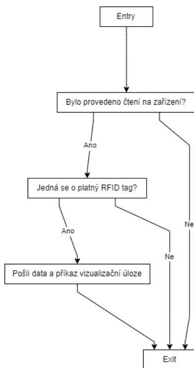
Obr. 2.2: Diagram vygenerovaný podle pseudokódu ve výpise 2.1 při volbě rozvržení svislého toku
