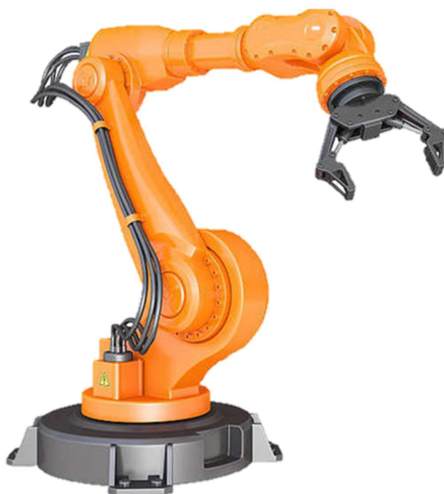
Obr. 38 Karteziánský kloubový robot s rotačním efektozem [17]
