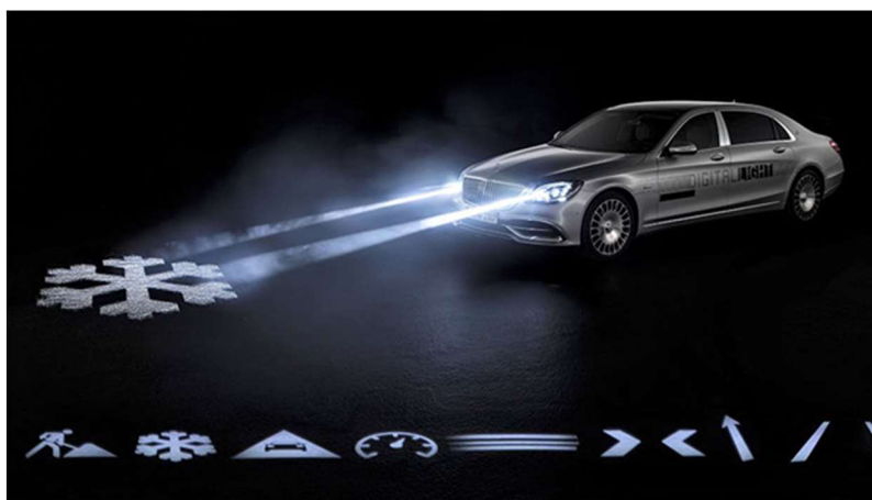
Obr. 22 Projekce prvků na silnici [7]
