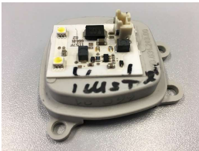
Obr. 6 Osazené keramické PCBA na plastovém chladiči
