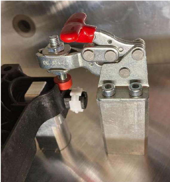
Obr. 47 Mechanická upínka fixující rámeček modulu
