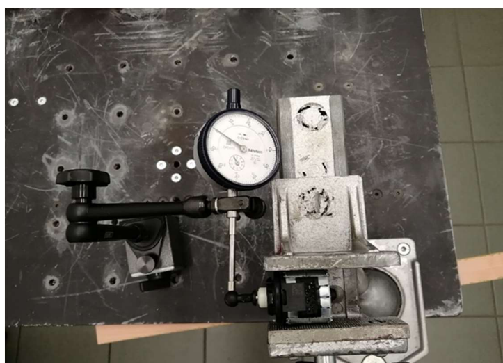
Obr. 33 Měření radiální vůle krokového motorku
