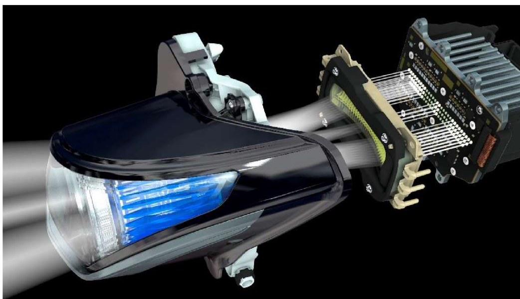
Obr. 18 Průběh toku světla od zdroje po výstup z modulu [4]
