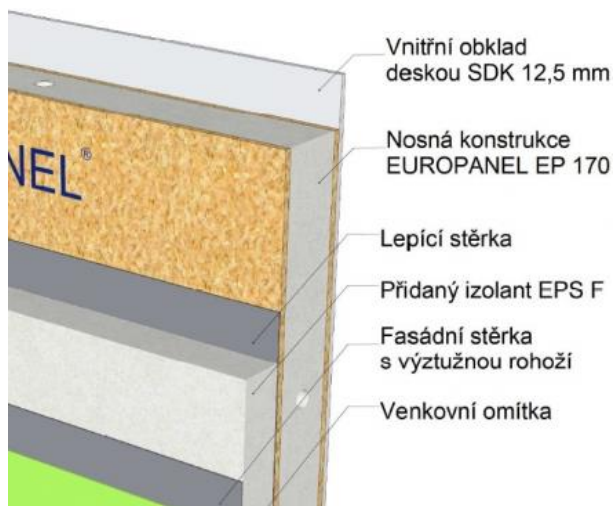
Obr.17 : Skladba stěny EUROPANEL [europanel.cz]
