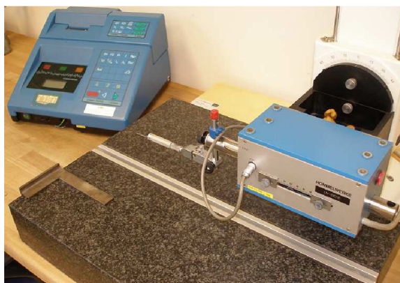
Obr. 6.2 Drsnoměr Hommel T 2000
