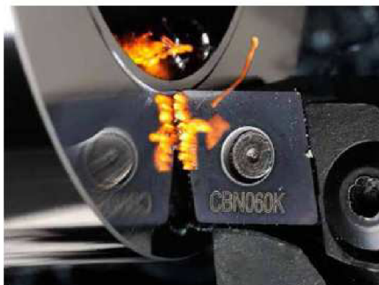
Obr. 3.14 Soustružení PKNB bez chladicí kapaliny [23]
