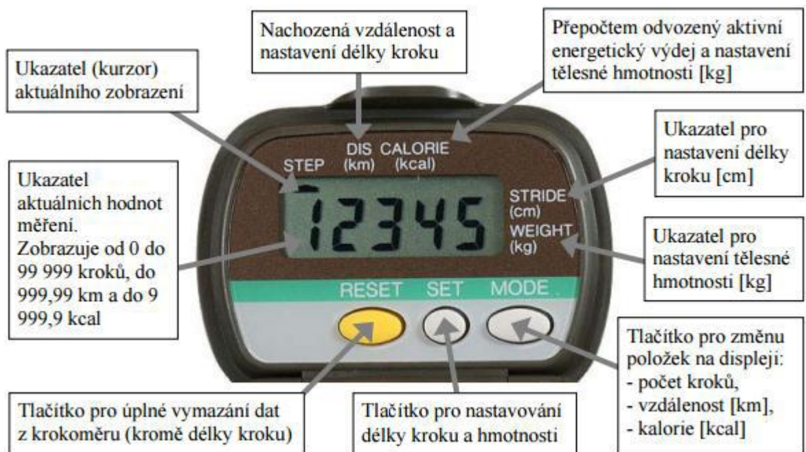
Obrázek 5. Displej krokoměru Yamax Digiwalker SW-700 s popisem ovládacích prvků (Sigmund & Sigmundová, 2011, 19)
