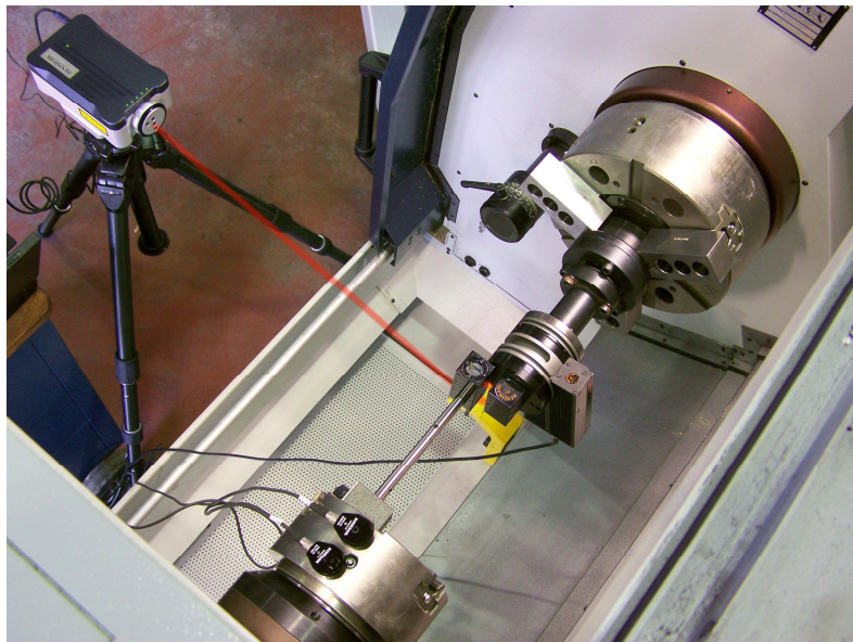
Obr. 1.14 Kalibrace vřetena pomocí systému XL-80. 3
