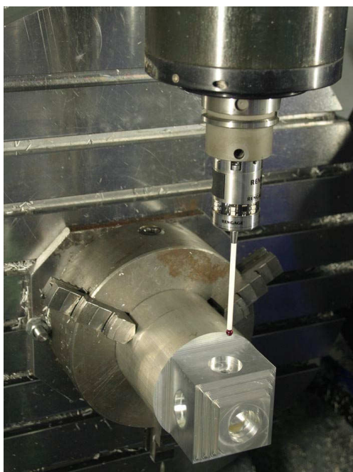
Obr. 5.13 Měření boční díry.
