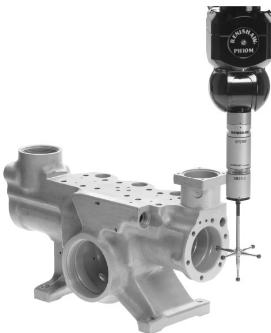
Obr. 1.10 Skenovací sonda firmy Renishaw SP25M. 3
