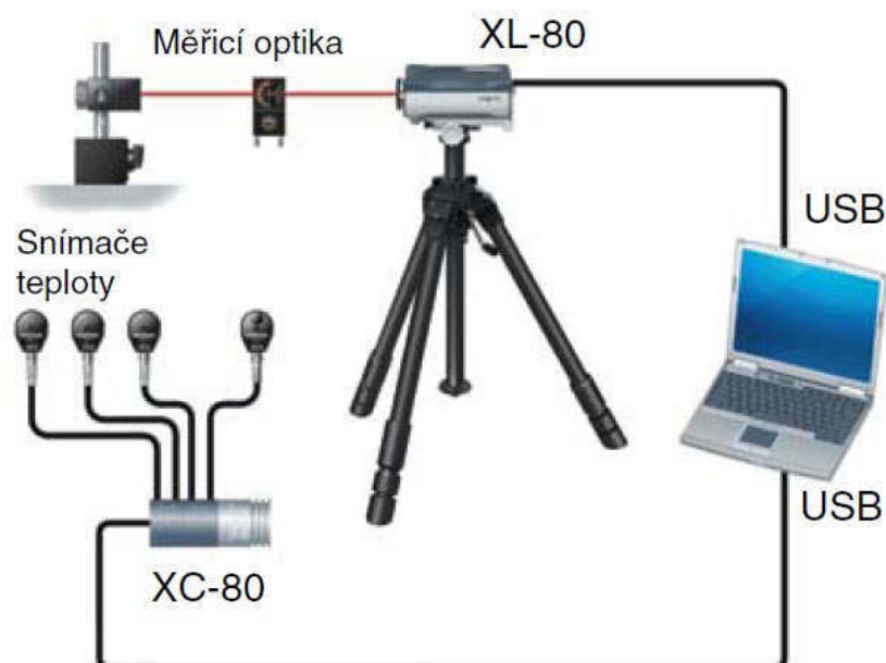
Obr. 1.13 Schéma laserového systému XL-80. 16
