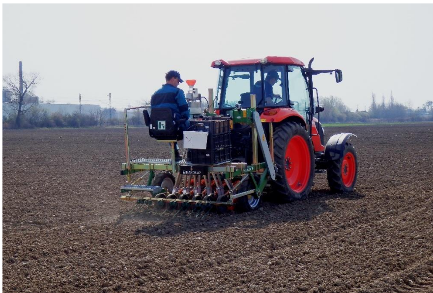
Obrázek 8: Maloparcelní secí stroj Haldrup SB-25 (foto: R. Koprna).
