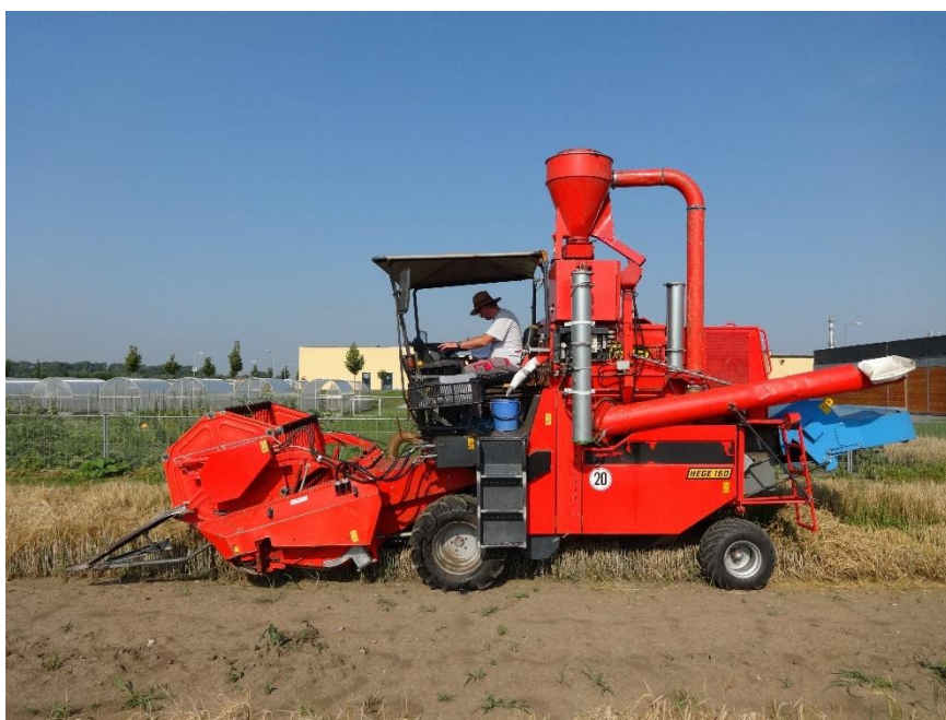
Obrázek 9: Maloparcelní sklízecí mlátička Hege 160 (foto: R. Koprna).
