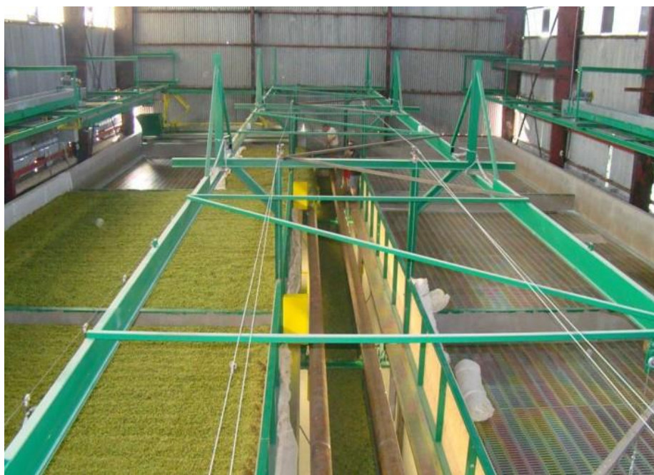
Obr. 10 Šest sušících komor v Mšeci [4]
