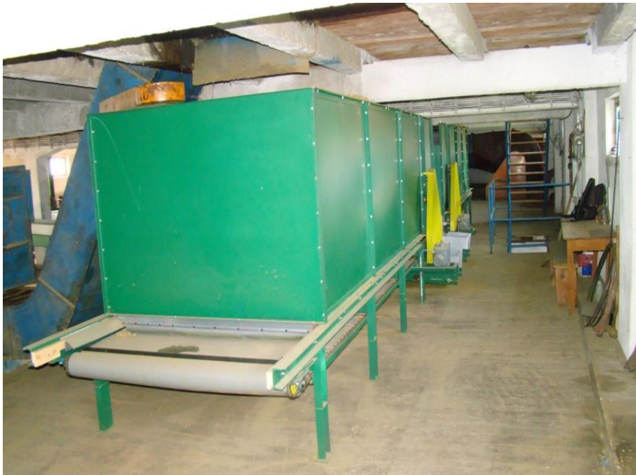
Obr. 16 Zásobník suchého chmele [4]
