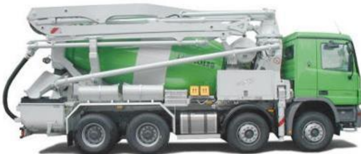
Obrázek 30: 7.1.9 - Autočerpadlo s domíchávačem betonu Putzmeister PUMI 21-3.67Q
