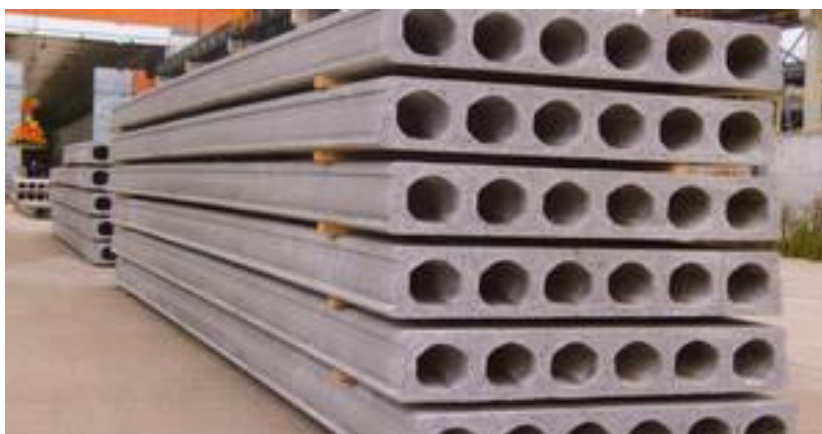
Obrázek 113: 14.3.1.8 - Správné skladování předpjatých stropních panelů Spiroll při nutnosti uskladnění
