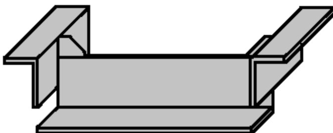
Obrázek 93: 12.5.5 - Ocelová výměna pro uložení střešních panelů Spiroll administrativy
