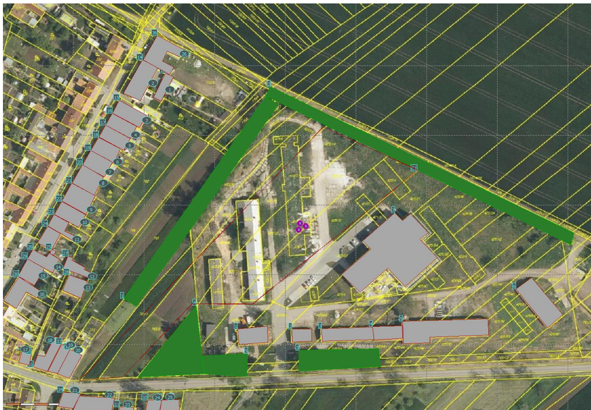
Obrázek 130: 16.5.1 - Výstup programu Hluk+ po vložení clony
