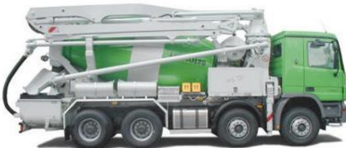
Obrázek 41: 7.2.5 - Autočerpadlo s domíchávačem betonu Putzmeister PUMI 21-3.67Q
