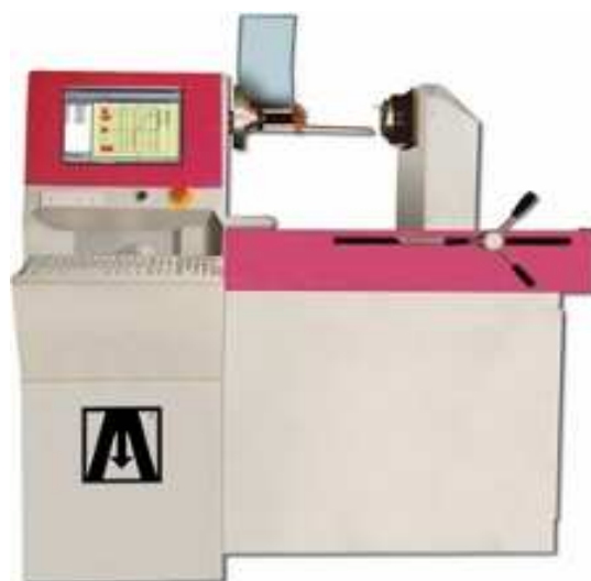
Obr. 2 Univerzální torzní stroj pro zkoušku krutem [18]
