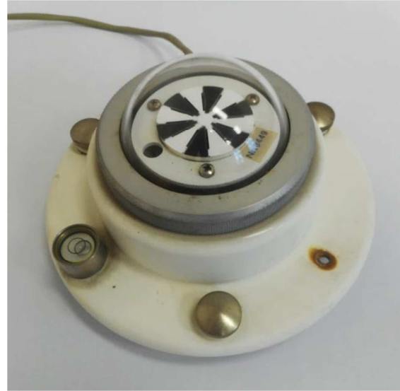
Obr. 6 - Segmentový pyranometr (foto autora)
