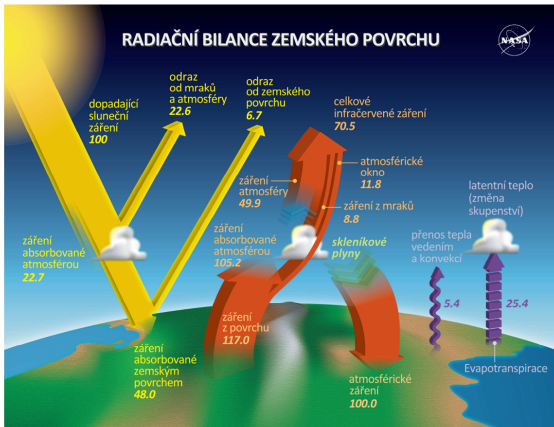
Obr. 2 - Radiační bilance zemského povrchu, hodnoty v % (Radiační bilance zemského povrchu, 2017)
